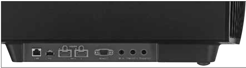
Das Anschlussfeld des VW300 gestaltet sich übersichtlich: Es bietet zwei HDMI-2.0-Buchsen, wobei eine davon HDCP 2.2 unterstützt. Außerdem sind LAN-, USB- und RS232-Schnittstellen vorhanden sowie zwei Trigger-Ausgänge zur Steuerung von Leinwänden oder ähnlichem.
