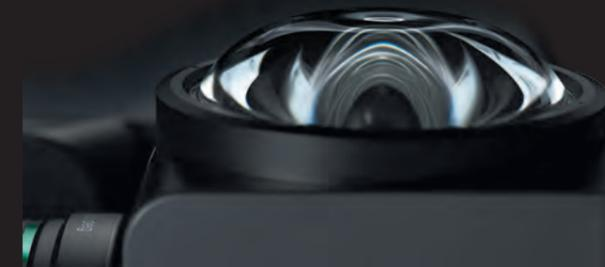
Für das Frontelement (G1) wird eine asphärische Linse mit großem Durchmesser eingesetzt. Die Herstellung großer und komplexer asphärischer Linsen erfordert eine besonders anspruchsvolle Technologie für das Formen und die weitere Verarbeitung. Die asphärischen Linsen haben einen Durchmesser von 87 mm und verfügen über eine extreme Projektionsgenauigkeit von bis zu 1 µm, was einen ultrakurzen Projektionsabstand mit großer Projektionsfläche ermöglicht.
