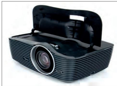
Geschickt versteckt: Das Einstellrad für die Shift-Funktion liegt unter einem Deckel. Dort befindet sich auch die Öffnung für den Wechsel der Ersatzlampe.
