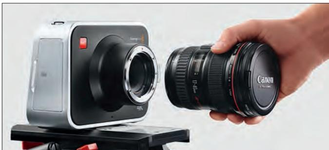
**An der Blackmagic Production Camera 4K können Canon-EF-Objektive, das Zeiss PL oder mit Adapter auch andere Objektive verwendet werden. Sie bietet auf der Rückseite ein großes Touch-Display und seitlich einen Einschub für SSD-Karten zur Aufzeichnung der Videos.**
