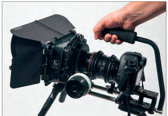
**Durch ein Rig mit Mattebox und Fokuspuller für eine DSLR zur Verbesserung der Bedienbarkeit wird die Einheit groß und teuer – sie kann mehrere Tausend Euro kosten. Dieser Aufwand lohnt nur für sehr ambitionierte Amateure oder Profis.**
