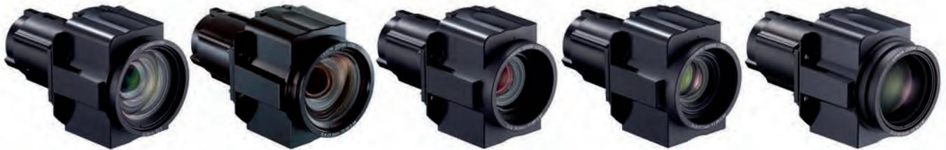
Canon bietet fünf Wechselobjektive: ein festes Weitwinkel mit einem Projektionsverhältnis von 0,8:1, ein Weitwinkelzoom mit 1:1 bis 1,5:1, das Standardzoom mit 1,5:1 bis 2,3:1, ein Telezoom mit 2,19:1 bis 3,74:1 und das Super-Telezoom mit 3,55:1 bis 6,94:1
