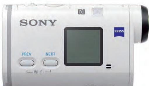
Die Sony X1000V besitzt ein Zeiss Tessar mit einem Bildwinkel von 170 Grad, Wi-Fi und GPS. Das Gehäuse ist spritzwassergeschützt, ein Unterwassergehäuse ist im Lieferumfang enthalten.
