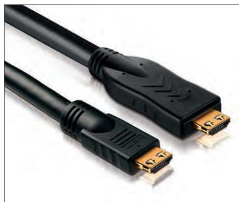
Die HDMI-Kabel von PureLink besitzen zusätzliche Federn, damit der Stecker sicherer im Gerät sitzt. Die aktiven HDMI-Kabel von PureLink (oben) besitzen einen integrierten Verstärker im Stecker, der in den Monitor oder Beamer gesteckt wird. Mit einem aktiven Kabel können bis zu 40 Meter überbrückt werden.
