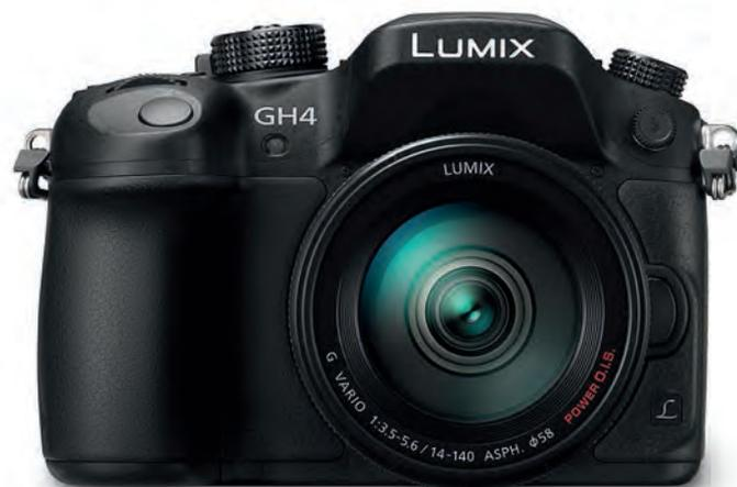
Die Panasonic GH-4 ist eine spiegellose Systemkamera mit Four-Thirds-Sensor mit 16 Megapixeln. Beim Filmen in 4K werden jedoch nur  $3.860 \times 2.160$  bis  $4.096 \times 2.160$  Pixel der Sensorfläche genutzt, wodurch eine hohe Qualität entsteht, weil nicht skaliert werden muss. Leider entsteht ein zusätzlicher Crop-Faktor von 1,3.
