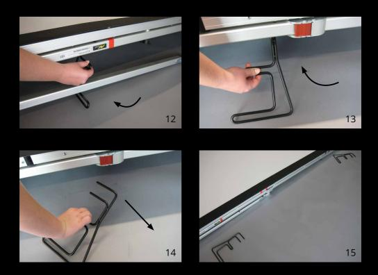
12 - 15 Nachdem auf beiden Rahmenseiten die Füße befestigt sind, werden die Montagehilfen zwischen Rahmen und Fuß durch Drehen um 90° entfernt.
